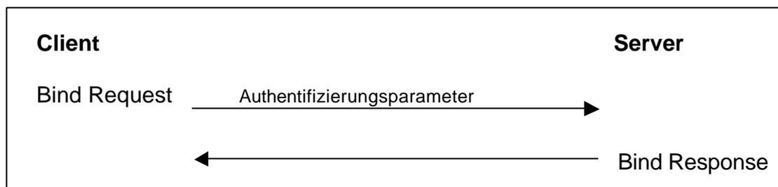
Abb. 7: DAP-Verbindungsaufbau
